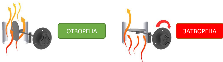
Схема III – 2.2. Управление на клапата на димоотвода
